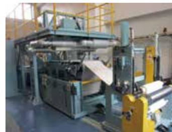
メルトブローン製造装置(自社開発装置)
