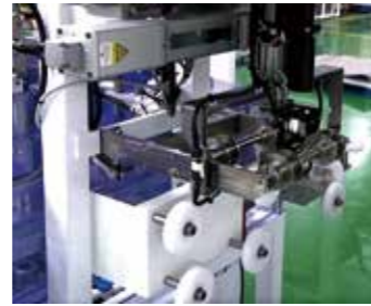
高精度CCDカメラが4列すべての ワイヤをリアルタイムで検査
