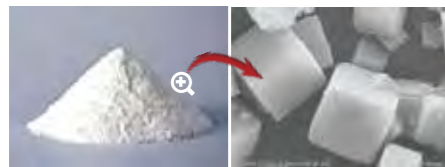
Si、Al、P等の元素から成るセラミックス粒子
